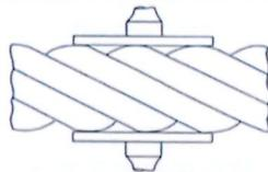
图 2-1 直径测量工具的型式
