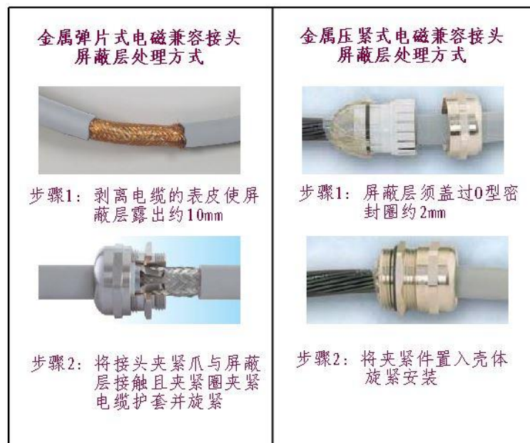
图 6-2 电磁接头屏蔽层处理方式
