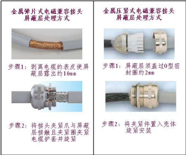
图 6-2 电磁接头屏蔽层处理方式
