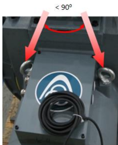
图 4-2 产品吊装示意图
