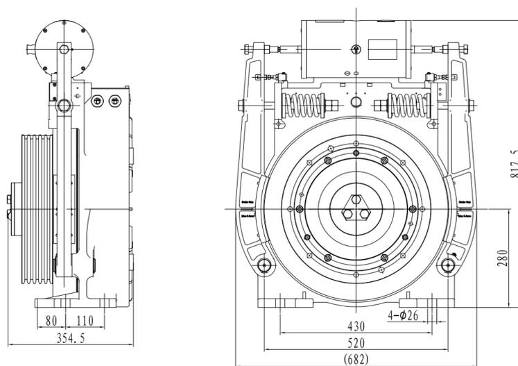
b) PMS280-F 曳引机（用 DMB520-1600A 制动器）的外形尺寸图
