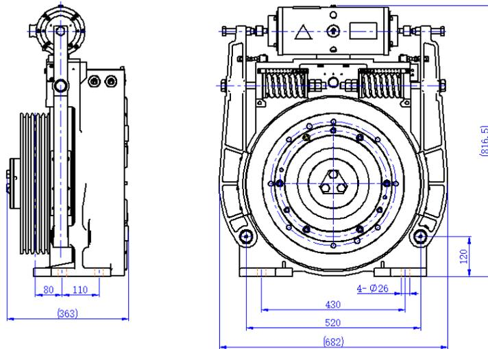
c) PMS280-F 曳引机 (用 DMB520-1800A 新制动器) 的外形尺寸图
