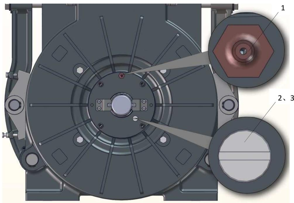
1) 油杯      2) 开槽盘头螺钉      3) 螺塞用密封垫
