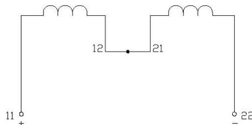
图 6-4 电磁铁接线图
