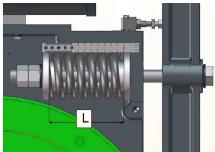
图 8-1 制动弹簧工作长度
