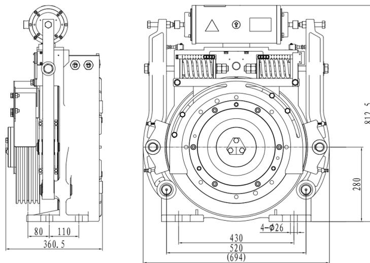
a) PMS280-F 曳引机（用 DMB520-1800A 制动器）的外形尺寸图
