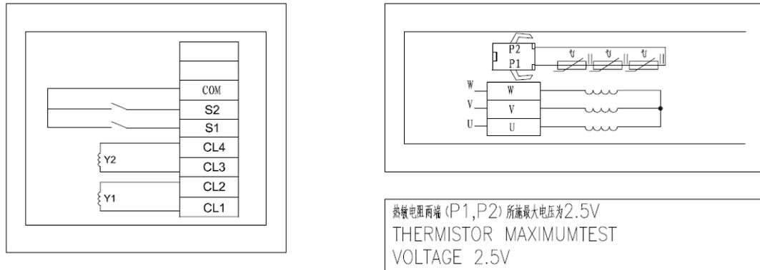
图 6-2 PMS280-F 曳引机接线图
