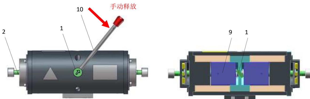
a) DMB520-1800A 制动器的电磁铁组件
