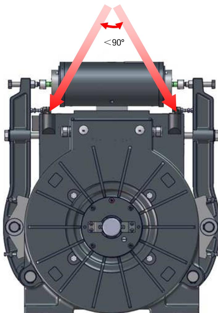
图 4-2 产品吊装示意图
