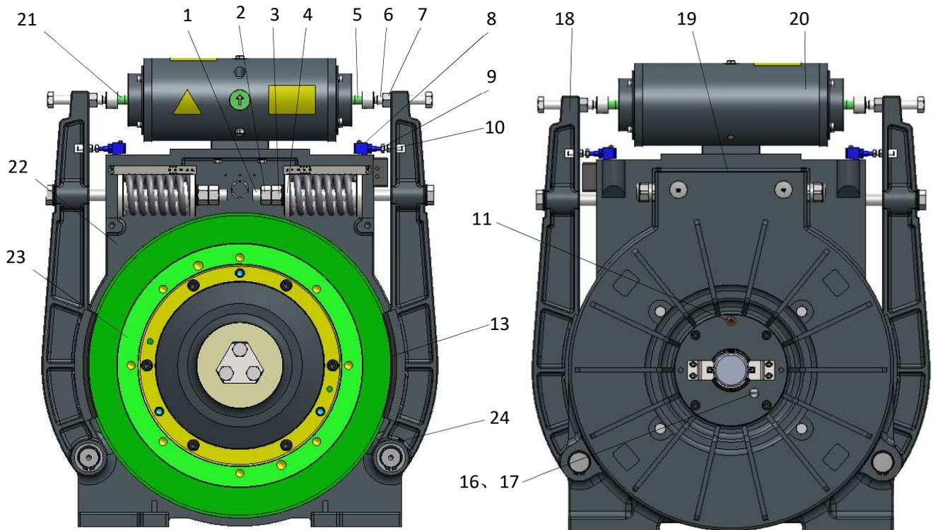
c) PMS280-F 曳引机 (用 DMB520-1800A 新制动器) 示意图
