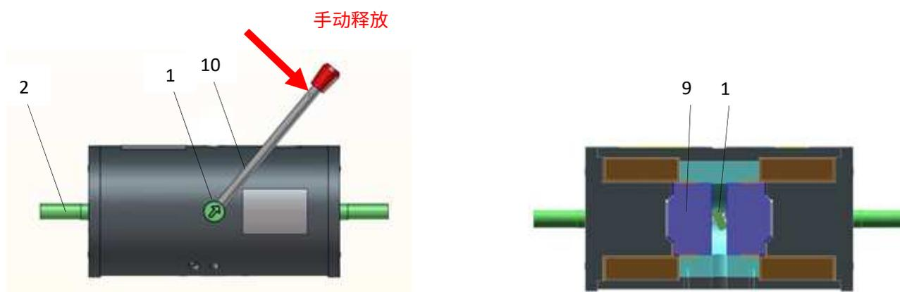
b) DMB520-1600A 制动器的电磁铁组件
