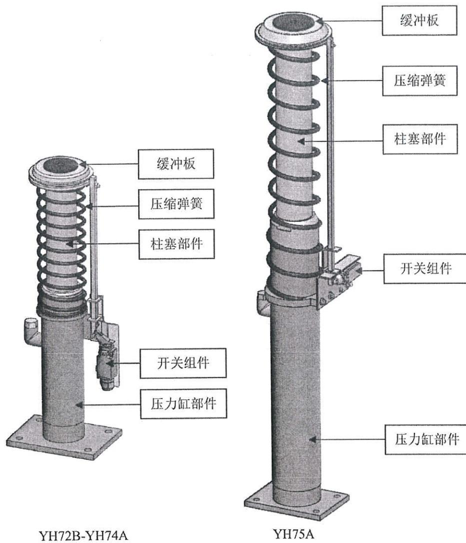
图 1 缓冲器结构示意图
