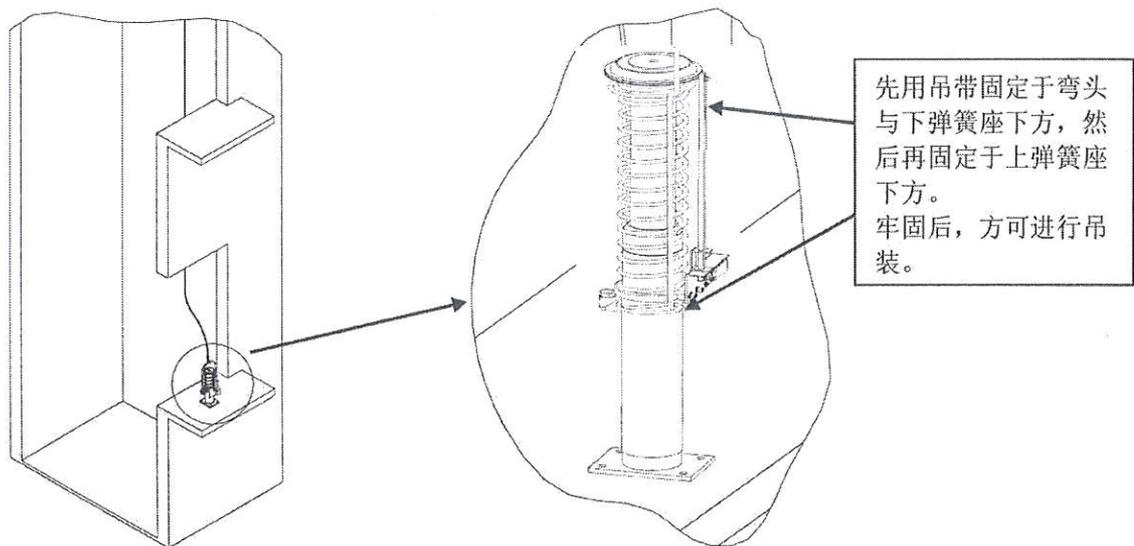
图 3 吊装示意图
